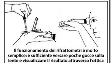
Il funzionamento dei rifrattometri è molto semplice: è sufficiente versare poche gocce sulla lente e visualizzare il risultato attraverso l'ottica
